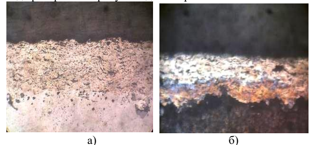
Рис. 2. Оптичні фотографії покриття Ni_3Al-SiC : а – вихідне після нанесення газотермічним методом; б – після випробування на корозійну стійкість в середовищі авіаційного палива з присадками зб. 200.
